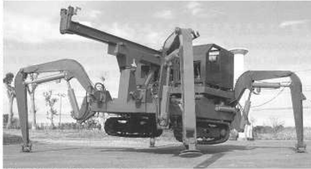
写真2 建設作業用4足歩行ロボットTITAN XI
