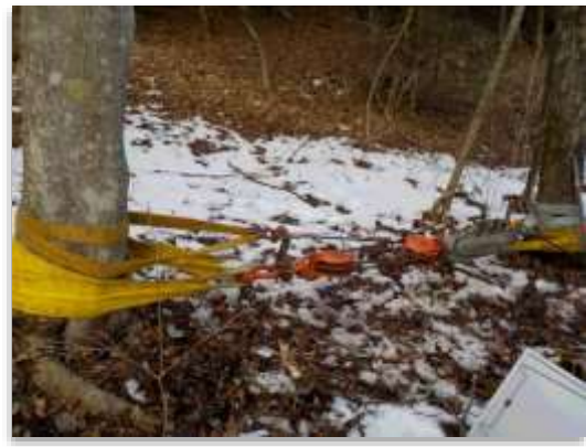
斜面上部の生立木根株使用のアンカー(アンカー引張試験)
