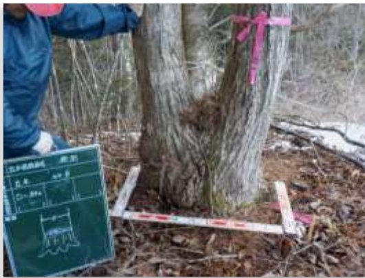
斜面上部の生立木根株使用のアンカー(アンカー引張試験)
